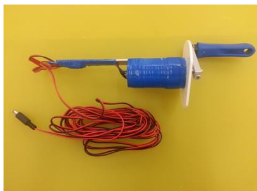
第一種發電裝置：24V 350 rpm 手搖發電機
